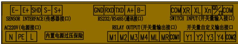
图 1 控制器后面板接线定义图
